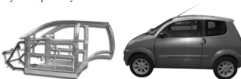
Rys. 2. Konstrukcja lekkiego pojazdu elektrycznego MEGA eCITY
