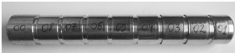
Rys. 2. Widok wałka ze staliwa duplex GX2CrNiMoCuN25-6-3-3; czopy nr 01–08 po nagniataniu (tab. 1), czop nr 00 po toczeniu
